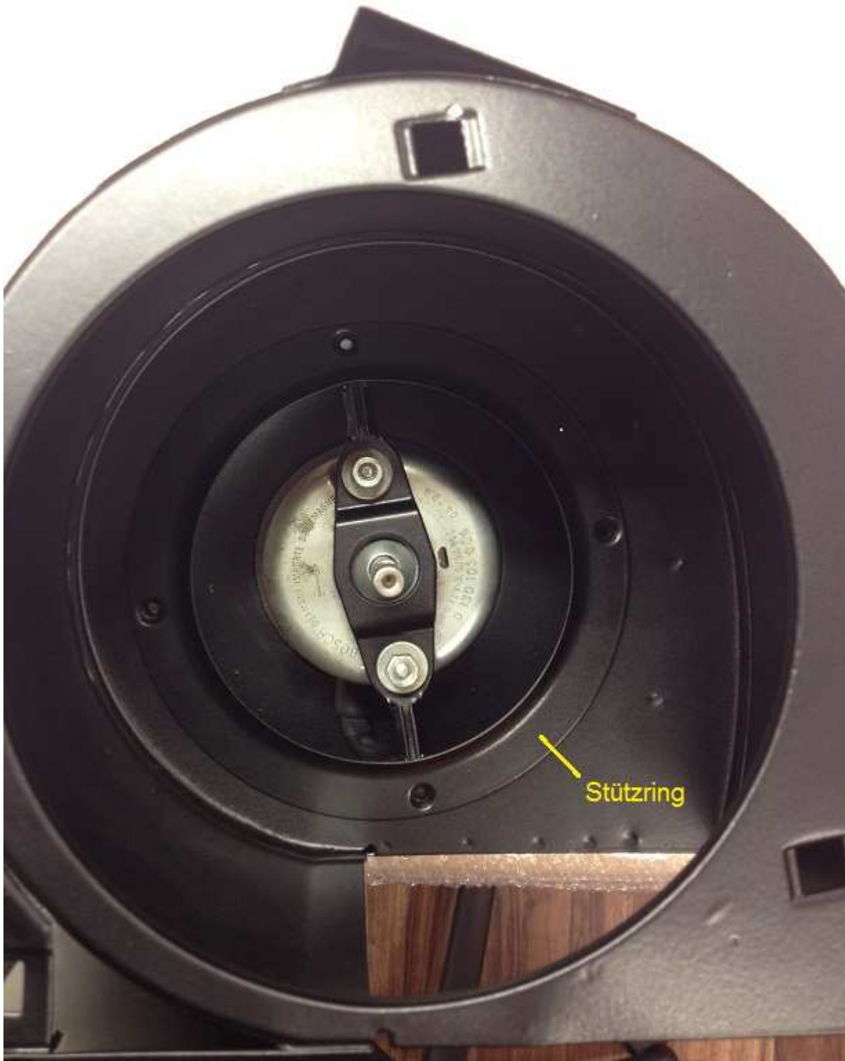
Motor mit Stützring eingebaut
