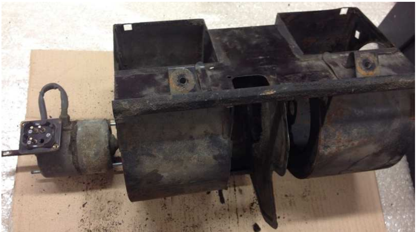
Motorleitung ausfädeln und Motor herausnehmen
