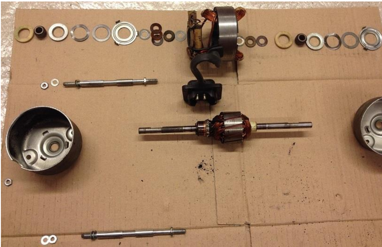
Läufer komplett ausgebaut / zerlegt
