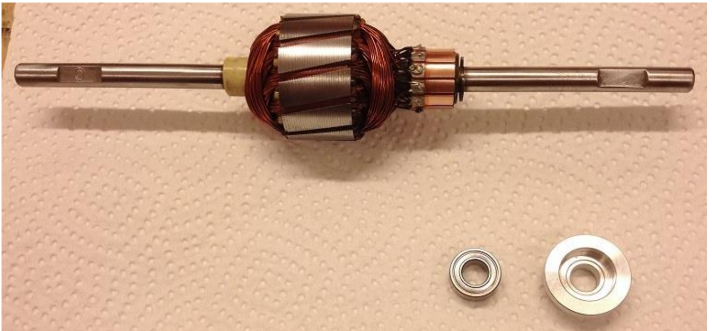
Gereinigter und (mit Vliesronde) polierter Läufer
