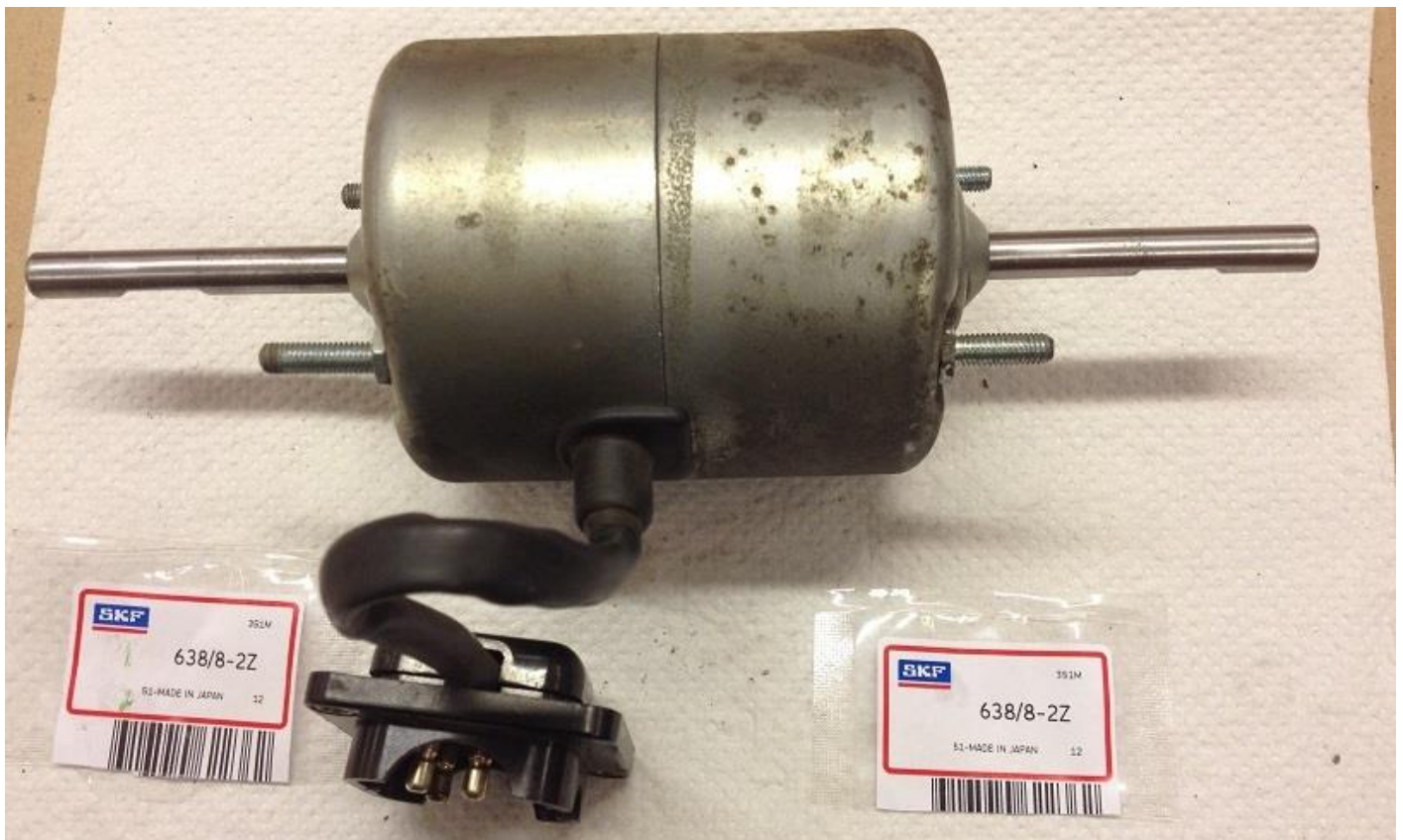
einbaufertiger Lüftermotor - läuft insgesamt leiser und mit etwas mehr Drehzahl / Luftdurchsatz.
