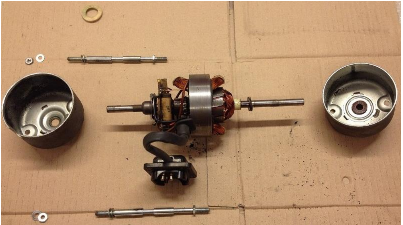
Demontierte Gehäusehälften
