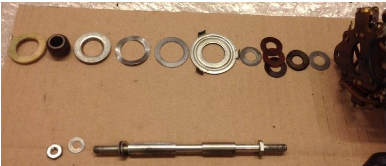
Einzelteile Kommutator-Seite
