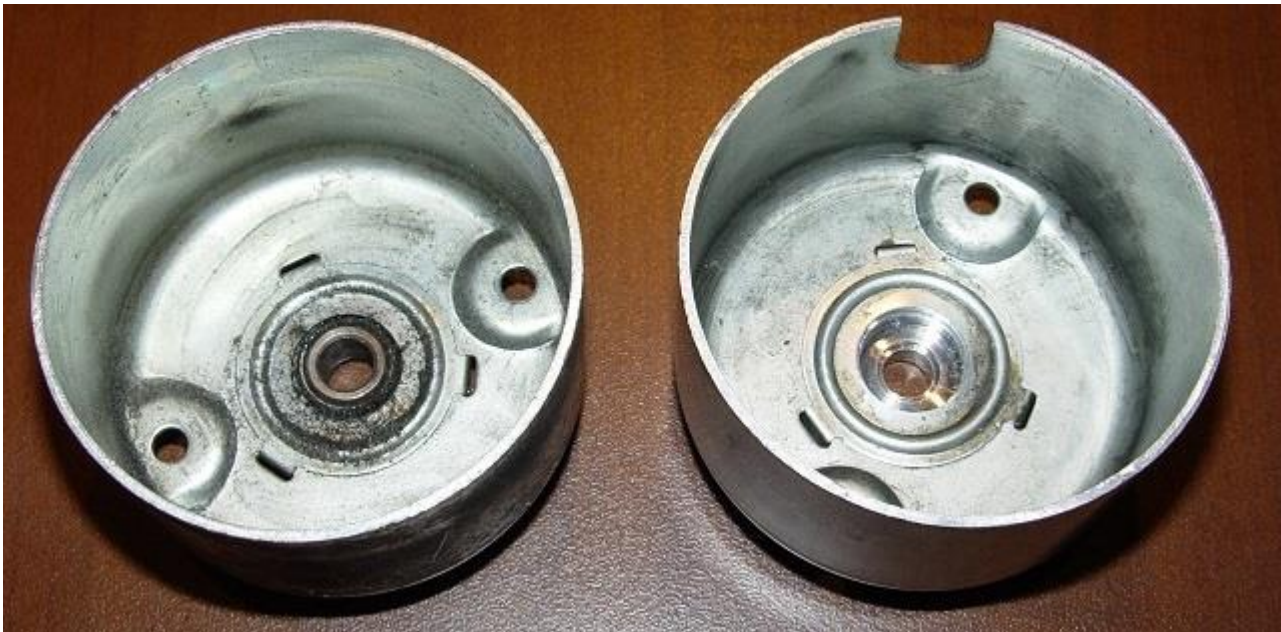
Links das ursprüngliche Sinterlager-Paket
