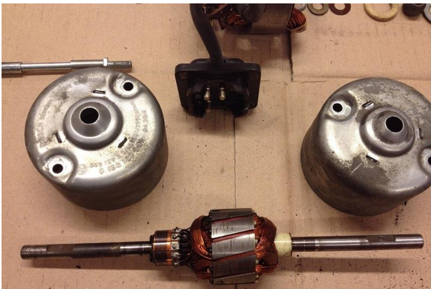
Zuordnung Gehäusehälften: Kommutator-Seite (links)
