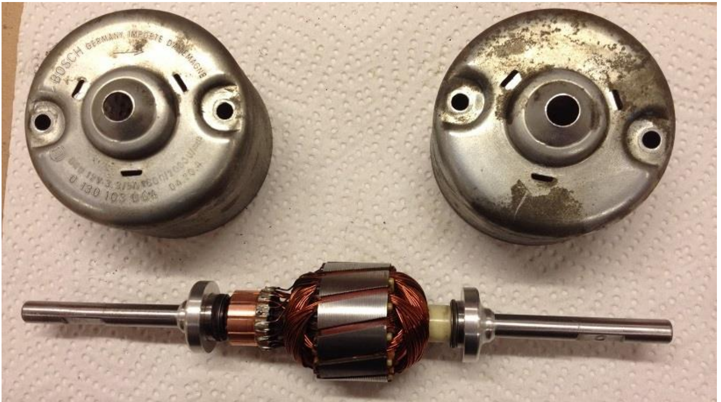
Gesamtansicht Läufer mit aufgezogenen Kugellagern und Lagerschalen
