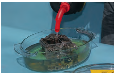
Vorteil Varajet: Die Schwimmerkammer dieser Vergaser-Konstruktion lässt sich mit dem Kanister recht einfach befüllen
