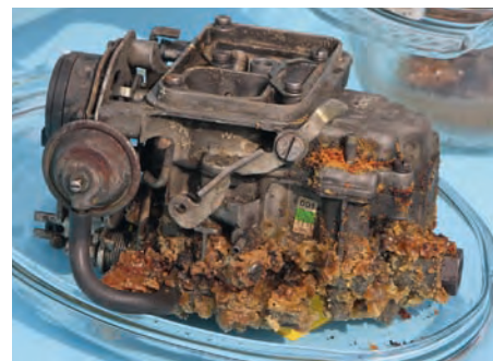
Die kristallinen Ablagerungen der E85-Probe sind durch Verdunsten des Ethanols entstanden
