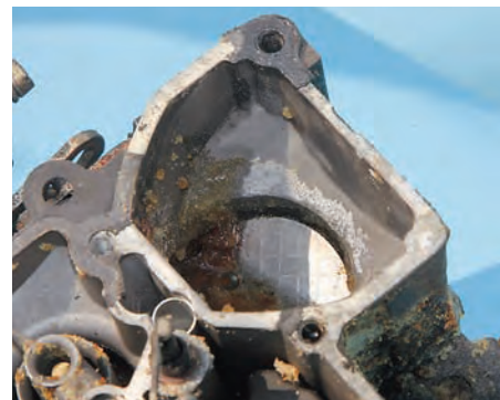
Die weißen Korrosionsspuren der E5-Probe sind auf wässrige Zerfallsprodukte zurückzuführen
