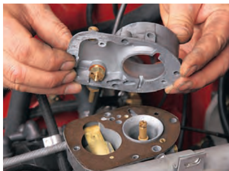
Auch ohne Ausbau lässt sich schnell prüfen, ob sich in der Schwimmerkammer durch den Biosprit Ablagerungen gebildet haben
