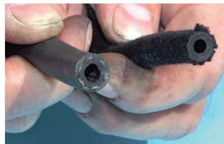
...hinterlassen. Zusätzlich zum Vergaser kommen zwei Benzinschläuche ins Bad: Ein Vollgummi- sowie ein gewebeummantelter Schlauch (r.)
