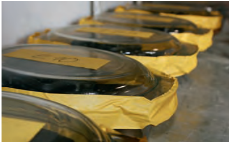
Ein Jahr reiften unsere Ansätze lichtgeschützt und gut abgedichtet im Regal. Von den jeweils vier Litern Kraftstoff blieb trotzdem wenig übrig
