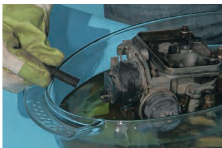
Die Schläuche werden nicht die ganze Zeit im Sprit verbringen – erst an der Luft zeigt sich, ob sie durch den Kraftstoff geschädigt wurden
