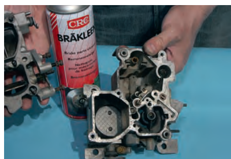
Opel-Varajet-Vergaser aus den Achtzigern: Teile aus dieser Ära könnten Ethanol übel nehmen, daher verwenden wir sie für unseren Test
