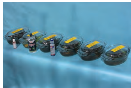
Das Ergebnis des Tages: Sechs Ansätze mit je vier Litern unterschiedlichen Kraftstoffs. Ein Jahr lang soll nun er auf die Vergaser wirken
