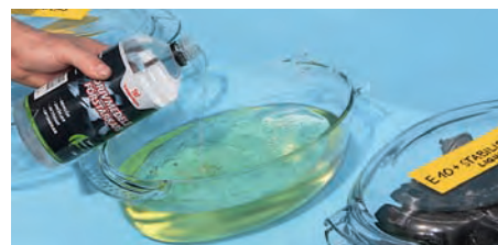
April 2011: Wie schützen Benzinzusätze Vergaser und Spritschläuche in E-10-Kraftstoff? Sechs Testgefäße setzten wir an und warteten ein Jahr
