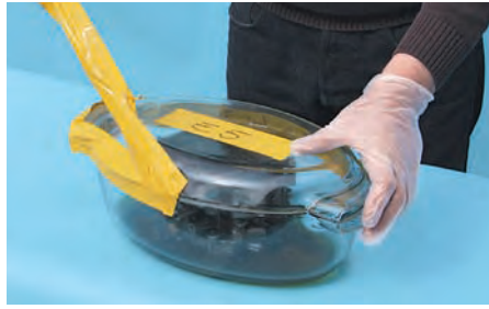
Gelöster Schmutz sorgte für die Verfärbung des Benzins – und in manchen unserer Gefäße auch die zersetzten Schlauchleitungen
