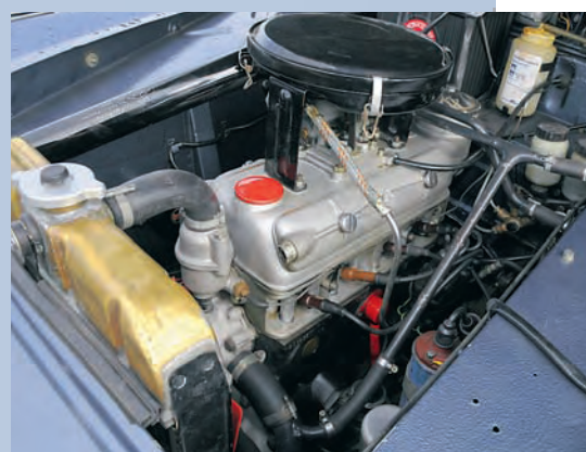
Die Aluminium-Komponenten alter Motoren (hier ein Borgward-Isabella-Triebwerk) werden von E10 nicht angegriffen
