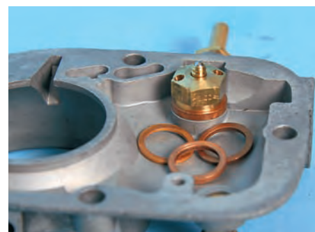
Materialmix: Das Schwimmernadelventil besteht aus Messing, die Dichtungen aus Kupfer, oft findet sich auch Aluminium
