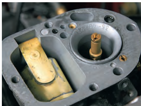
Messingschwimmer wie dieser sind nicht gefährdet. Für Kunststoffe gibt es noch keine umfassenden Aussagen der Hersteller
