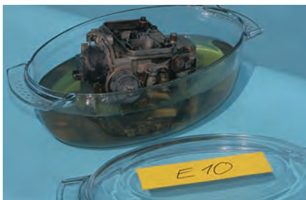
Das Gehäuse soll auf jeden Fall ein Stück aus dem Benzinbad herausragen, die hygroskopische Wirkung des Ethanol's könnte hier Spuren...
