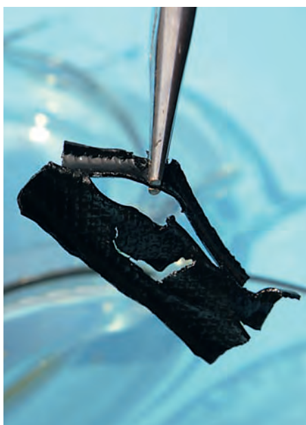
Ausgerechnet das vermeintlich bessere E5 zerstörte diese Gummileitung vollständig
