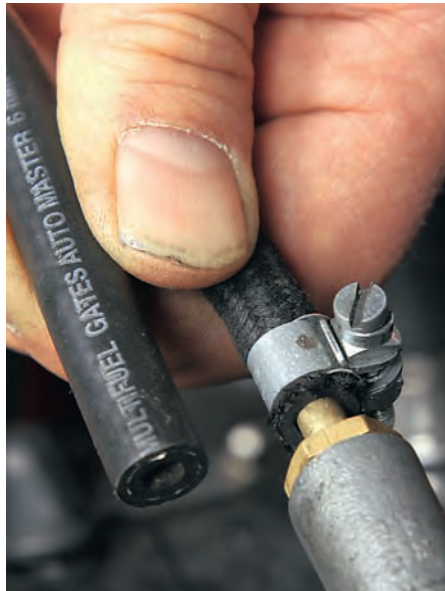
Alte Benzinschläuche sind E10-empfindlich. Sie sollten gegen Neue mit dem Materialkürzel NBR/CR ausgetauscht werden (DIN 73379-1)
