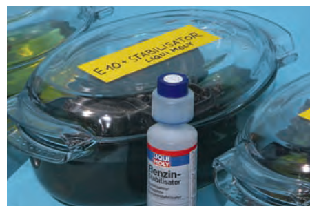
Nach kurzer Zeit färben sich die Gemische bereits unterschiedlich ein – im Liqui-Moly-Stabilisator geht's am finstersten zu
