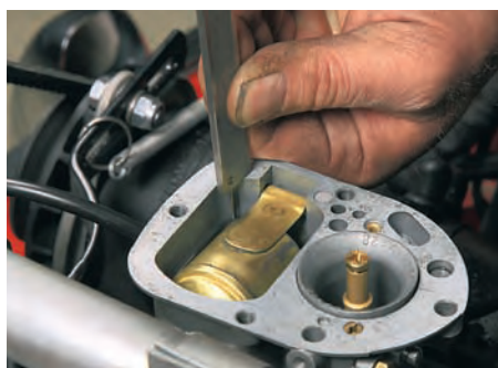
Bevor die Gemischfabrik neu abgestimmt wird, sollte der Schwimmerstand überprüft und bei Bedarf eingestellt werden
