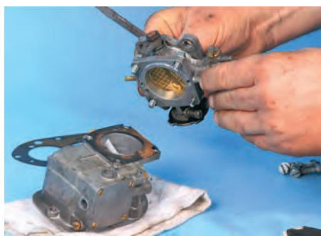
Schau doch mal rein: Das Zerlegen und Reinigen eines Vergasers ist kein Hexenwerk. Fehlende Teile können zum Problem werden
