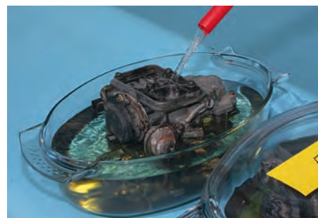
...aber seriöserweise nicht. Wir machen die Probe aufs Exempel und schicken Vergaser auf Tauchgang in verschiedene Kraftstoff-Rezepturen
